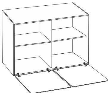
Posizionare 2 ante (7) adiacente al fianco sx (3) con i fori delle cerniere ai rispettivi fori sul fianco. Inserire e fissare le cerniere (10) nei fori posti sull'anta e sul fianco ed avvitare come mostrato in figura. Capovolgere il mobile e ripetere l'operazione con le altre ante sul fianco dx (2).
