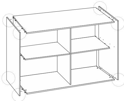
Chiudere il telaio così ottenuto con il coperchio (1) e la base (6), infilandoli nei rispettivi fori posti sui fianchi e sulla tramezza con i perni per eccentrico (18).
