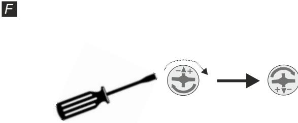
Ruotare gli eccentrici (17 e 18) posizionati sui fianchi (2) e sulle tramezze (3) in senso orario in modo da fissare il coperchio e base alla tramezza ed ai fianchi. Coprire gli eccentrici (17 e 18) con i tappini copriforo (19).
