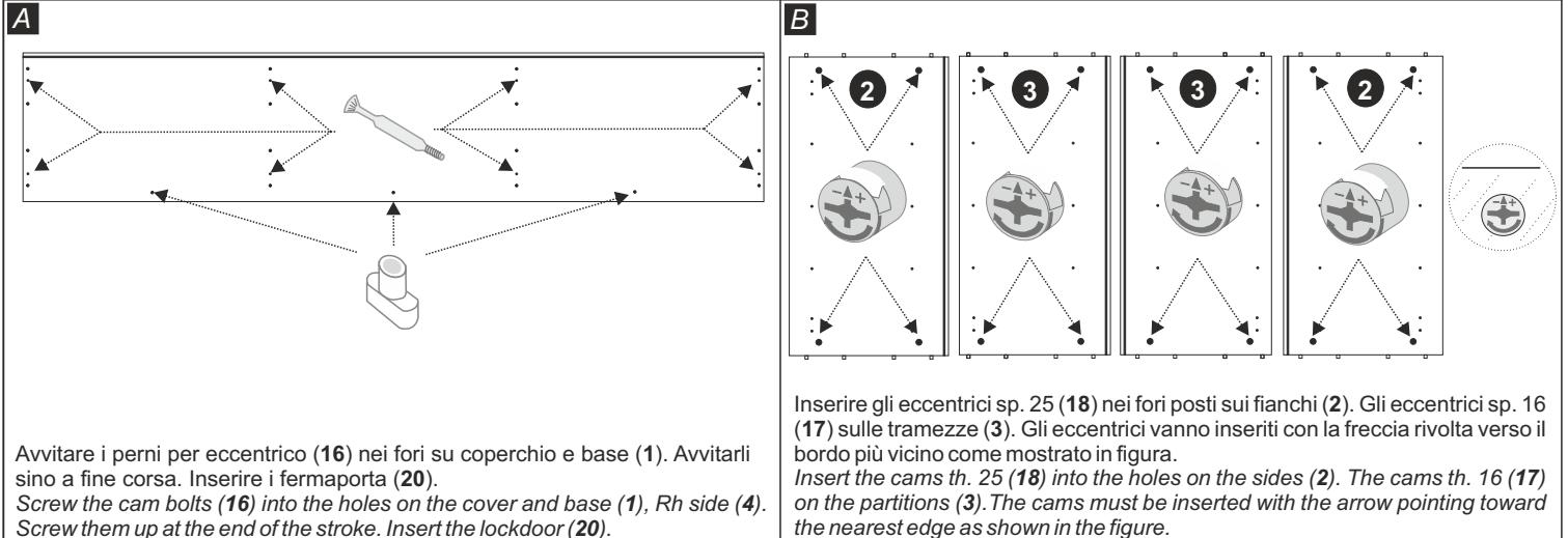
Avvitare i perni per eccentrico (16) nei fori su coperchio e base (1). Avvitarli sino a fine corsa. Inserire i fermoporta (20).
