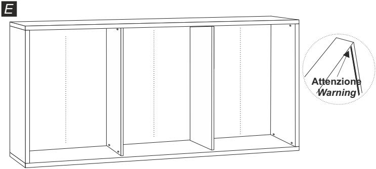
Chiudere il telaio così ottenuto con il coperchio (1) infilandolo nei rispettivi fori posti sui fianchi e tramezze con i perni per eccentrico (16). **Attenzione: non rompere i bordi alle estremità della fresata.**
