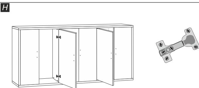
Inserire le cerniere a collo dritto (9) su 2 ante (6). Posizionare un anta con le cerniere a collo dritto (9) adiacente alla tramezza (3), con le viti della cerniera sui rispettivi fori sulla tramezza e fissarle. Ripetere l'operazione sull'altra tramezza con l'altra anta con le cerniere a collo dritto (9).
