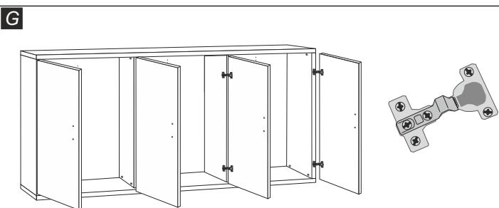
Inserire le cerniere a collo alto (10) su 4 ante (6). Posizionare un anta con le cerniere (10) adiacente al fianco (2), con le viti della cerniera sui rispettivi fori sul fianco e fissarle. Ripetere l'operazione sull'altro fianco con l'altra anta con le cerniere a collo alto. Ripetere l'operazione precedente con le restanti ante con le cerniere (10) posizionate adiacenti alle tramezze (3) centrali e fissatele.
