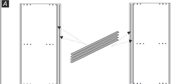
Inserire, a pressione, le guide (12) nelle apposite scanalature poste sul coperchio (1) e base (5).
