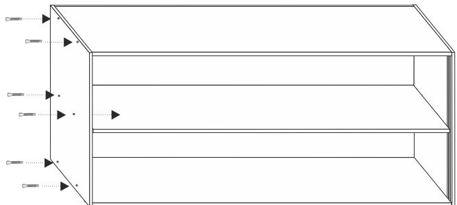
Chiudere il telaio così ottenuto con il coperchio (1), infilandolo nelle rispettive spine poste su fianchi e tramezza. Bloccare il coperchio (1) alla tramezza (4) ed ai fianchi dx (2) e sx (3), fissandolo con le viti 7x50 (16). Coprire quindi le viti con gli appositi tappini copritive (17).
