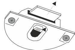
Inserire prima l'anta da porre sulla guida più interna del mobile, poi quella esterna. Per primo infilare la parte sporgente dei carrelli (14) nella guida posta sulla base (la ruota scorre sul bordo della guida). Internamente al mobile, estrarre i perni dei pattini (13), inserendoli nella guida posta sul coperchio. Ripetere l'operazione per fissare l'altra anta. **Attenzione: trattenerne le ante sino a fissaggio avvenuto, onde evitare la caduta.**
