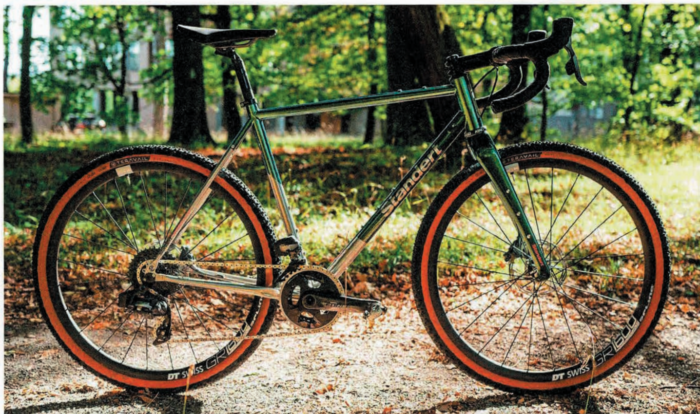
Größe: M, Ausstattung: Sram Force eTap AXS 43/30x10–36 (12x), DT Swiss RR 1600, Teravail Rutland 650bx47, Rahmenmaterial: Carbon, Oberrohrlänge: 560 mm, Sitz-/Lenkwinkel: 73,5°/72°, Stack/Reach: 568/391, max. Reifenbreite: 47 mm (650B), 2 x möglich: ja
