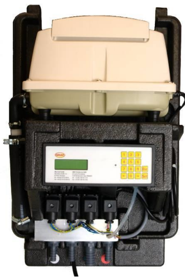
Armoire de pilotage interne ouverte avec embouts pour raccord des tuyaux d'air
