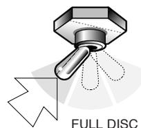
Der Tracker IV ist ein "Bewegungs"- Detektor. Das bedeutet, dass die Suchspule bewegt werden muss, um ein Metall zu erkennen. Wenn Sie mit einem Detektor üben, der z.B. auf einem Tisch liegt, bewegen Sie das Metallobjekt unter der Spule hindurch. Objekte, die nicht bewegt werden, werden nicht erkannt.
