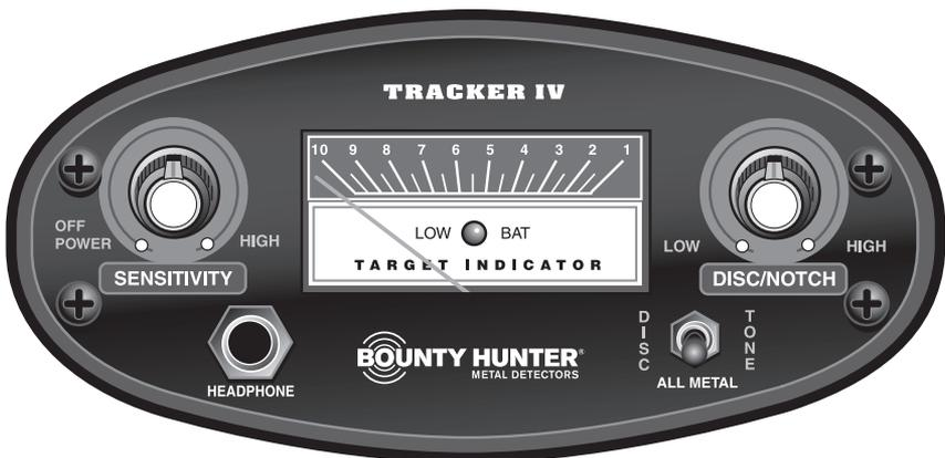
Um eine maximale Suchleistung zu erzielen, stellen Sie die Empfindlichkeit so hoch wie möglich ein. Die Empfindlichkeit kann in der Regel im Diskriminierungs- (DISC) oder Tonmodus (TONE) höher eingestellt werden.
