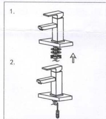
4. Réinstallez la rondelle en caoutchouc, puis la rondelle métallique et l'écrou de blocage, puis serrez à la main puis serrez à nouveau à l'aide d'un tournevis pour serrer les vis du contre-écrou.
