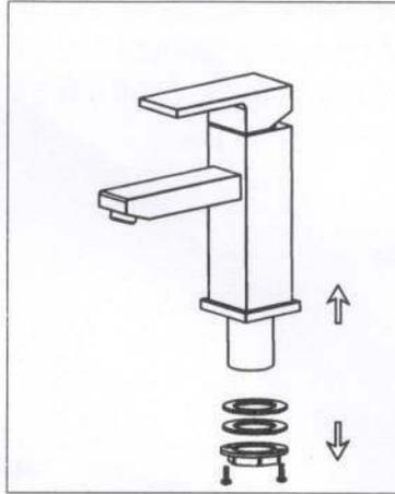
1. Retirez la rondelle en caoutchouc, la rondelle métallique et l'écrou de blocage du robinet.
