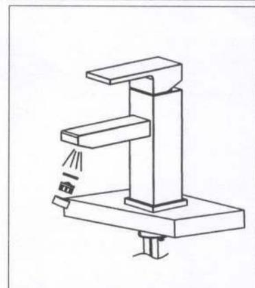
6. Enlevez l'aérateur et ouvrez le robinet pendant une minute pour rincer les débris du robinet et des conduites d'alimentation. Retirez le robinet et réinstallez l'aérateur.
