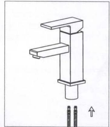
2. Visser et serrer à la main les flexibles chauds et froids au robinet NE PAS utiliser de clé pour serrer les flexibles car cela pourrait endommager le flexible et / ou les filetages du flexible.
