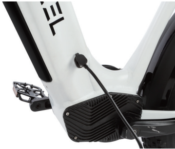
A. Recargar la batería en la e-bike directamente.
