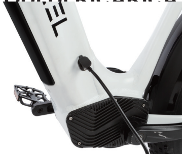
A. Ricarica della batteria direttamente sulla e-bike.
