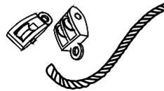
Después vamos a pasar uno de los extremos de la sogá por la roldana doble llevándola hacia la roldana simple, el sobrante de la sogá/segunda punta la pasamos por el ata sogá y volvemos a pasar el segundo extremo por la otra vía de la roldana doble, ambos extremos de la sogá se van a encontrar y atar en el puente de media fijado en el perfil 1.
