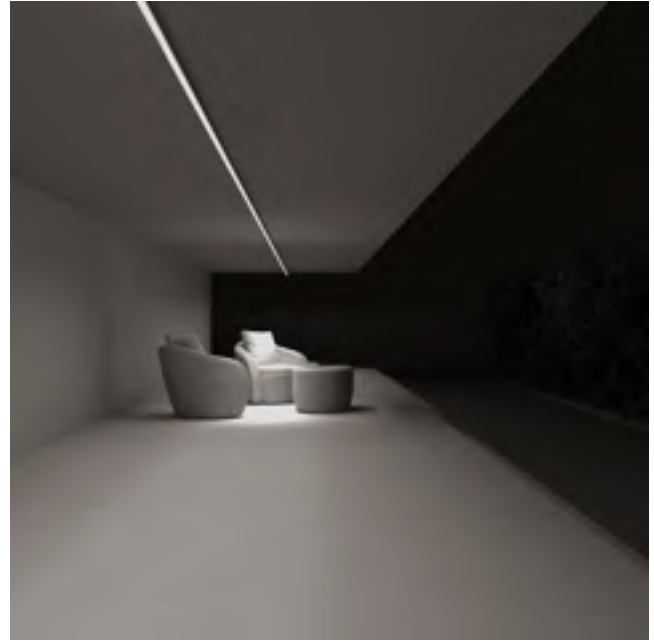
Concatenación de Taglio Opal y Optics de superficie en techo.
