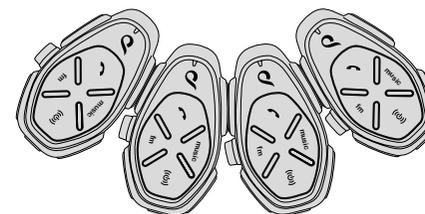
2. An der ersten Einheit auf der linken Seite ist **(RDS)** gedrückt zu halten, bis die LED rot/blau aufleuchtet. Der Vorgang wird automatisch beendet, wenn auch die letzte Einheit in den Stand-by-Modus zurückgekehrt ist (LED alle drei Sekunden blau). Sämtliche Einheiten sind nun angekoppelt.
