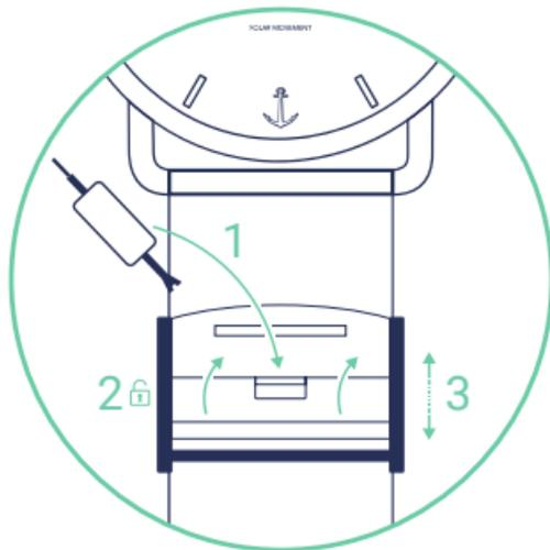
Führe ein Werkzeug oder einen anderen schmalen Gegenstand in die vorgesehene Öffnung (1). Durch eine leichte Hebelbewegung entsicherst du die Verriegelung (2). Anschließend kannst du den Schlitten ganz einfach auf die gewünschte Größe einstellen (3) und danach wieder feststellen (2).
