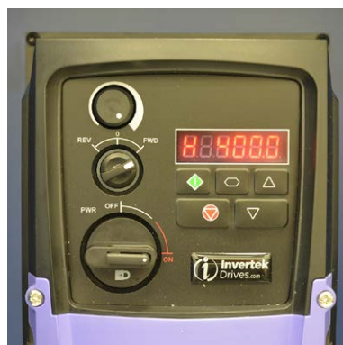
Fig. 8e Switch 3 set to the max 400 Hz
