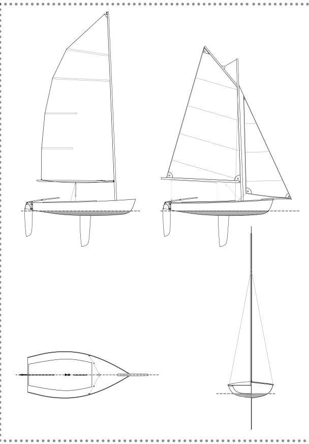
scafo: attrezzatura velica: sistema di costruzione: capacità richiesta: Carena tonda Sloop Aurico / cat Marconi Strip Planking Media esperienza lunghezza f.t.: m 3,04 larghezza: m 1,38 peso: kg 50 superficie velica: m² 7,60 Piani: n° 14 tavole formato A3 istruzioni lista materiali
