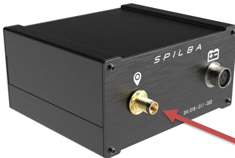
Figura 2. Conexión antena GNSS.
