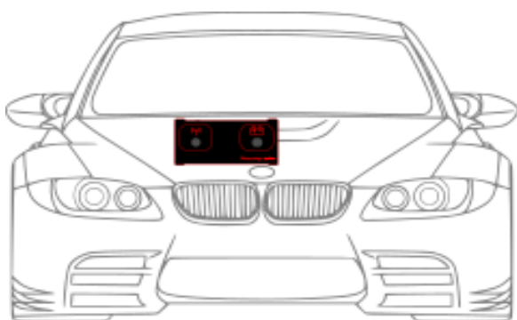
Figura 8.1. Vista frontal del vehículo. Debería verse la parte trasera del dispositivo, es decir, el conector de alimentación y antena GNSS.
