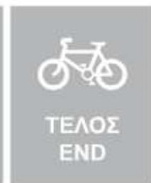
Σήμανση οδοστρώματος που υποδεικνύει το τέλος του ποδηλατοδιαδρόμου
