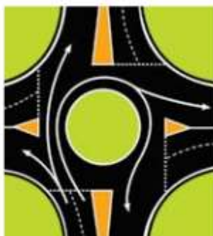
Κυκλικός κόμβος με δύο λωρίδες εισόδου
