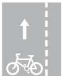
Τυπική σήμανση οδοστρώματος ποδηλατοδιαδρόμου
