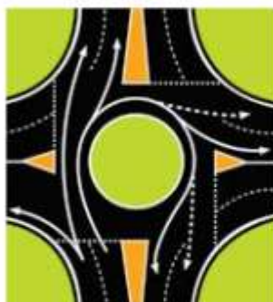
Κυκλικός κόμβος με δύο λωρίδες εισόδου
