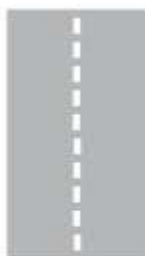
Διαχωριστική διαγράμμιση ποδηλατοδιαδρόμου από το υπόλοιπο οδόστρωμα κυκλοφορίας μηχανοκίνητων οχημάτων.
