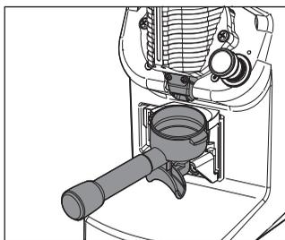
La macchina è dotata di dispositivo di tenuta del portafiltro. Questo dispositivo è predisposto per i portafiltri Standard Victoria Arduino, ma può essere regolato in base al portafiltro a disposizione.
