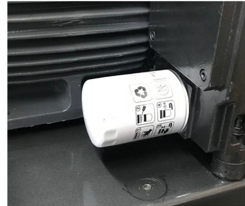
Si le cadran de pression indique une pression 1 psi en haut de 15'' hg un remplacement des filtres à la sortie est requis
