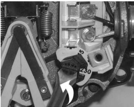
Figure 12 – Modification au réglage de la tension
