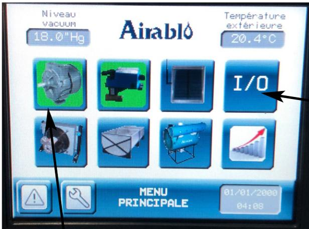
**Pour réduire la vitesse de la pompe à vide selon température (La pompe de type compact doit fonctionner à la vitesse minimum à 20''hg ou moins)**
