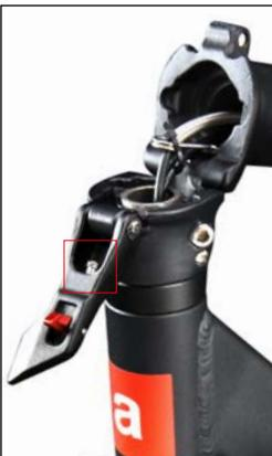
A photograph of the eSR2 or eSR2 EVO steering stabilizer mechanism. A red square box highlights the internal hexagonal screw located inside the mechanism housing. | Uvnitř mechanismu je umístěn šestihraný šroub.<br>Pokud je představec řídítka po zavření nestabilní, upravte šroub mechanismu tak, že jej zašroubujete nebo vyšroubujete, abyste zvýšili stabilitu představce.                    |
