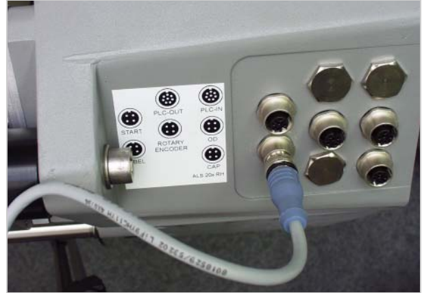
[6] Sensor connections on the ALS 20x (RH)
