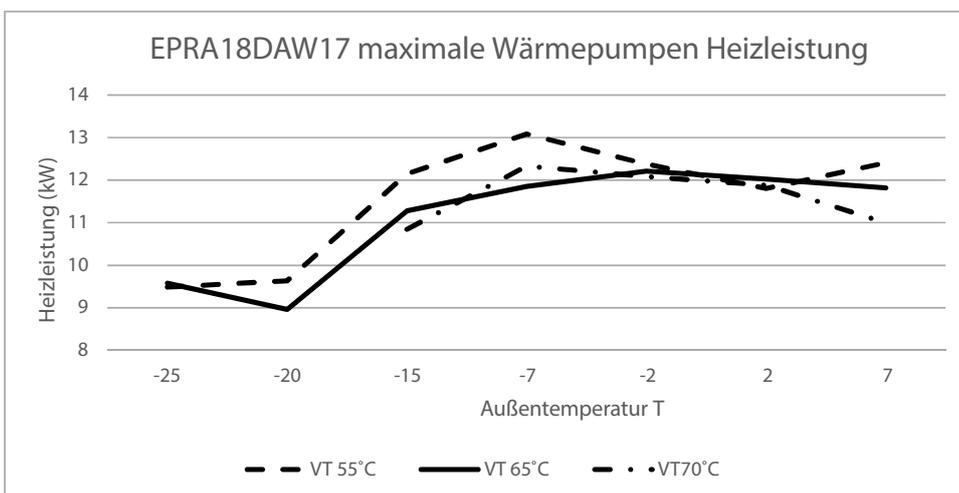
Heizleistung gemessen bei voller Kompressordrehzahl; Ta = Außentemperatur; VT = Vorlauftemperatur; HC = Heizleistung; PI = Elektrische Leistungsaufnahme
