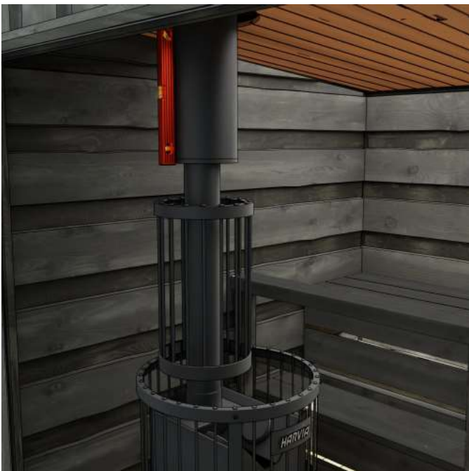
13. Kontrollera att skorstenen är rak. Flytta bastuaggregatet vid behov.
