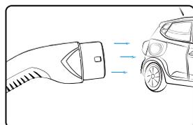
1. Éteignez le véhicule et insérez complètement la fiche du chargeur EV dans la prise de courant.
