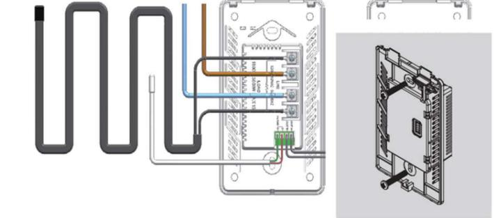
3. Installez le couvercle arrière dans la boîte à bornes et le fixer à l'aide de la vis.
