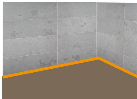
\* Assurez-vous que le sous plancher est exempt d'humidité et ne contient pas de poussière.
