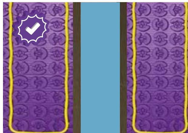
Les câbles chauffants ne peuvent pas être installés à travers des joints de dilatation dans le sol. Lorsqu'un plancher chauffant est divisé par des joints de dilatation, des câbles individuels doivent être utilisés pour chauffer chaque zone. Si nécessaire, le câble froid peut traverser le joint de dilatation à l'intérieur d'un conduit de 12" de long certifié UL/cUL.
