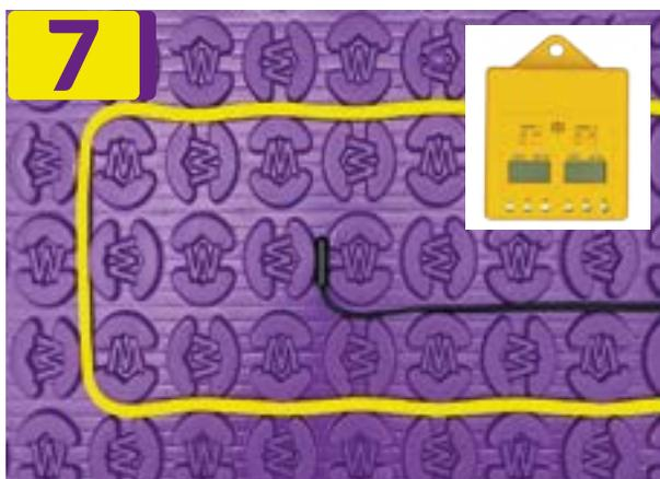
\* Mesurez la résistance du capteur de sol et enregistrez-la sur la carte de contrôle. Si la résistance est en dehors de la plage prescrite, contactez Drexma.
