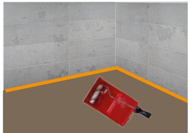
Installer des bandes de dilatation périmétrique dans le système DrexMat-Heat, le long de tout joint de dilatation périmétrique ou sectionnel dans le sous-plancher, afin de maintenir leur fonction. Pour l'installer, retirez le ruban adhésif de la bande périmétrique afin d'exposer le dos adhésif et commencez à la presser contre le mur, en veillant à ce que la bande touche également le sol. La pose de la bande périmétrale permet un mouvement différentiel entre le niveau du sol fini et les murs.
