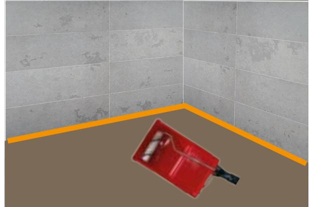
Si nécessaire, apprêter les sous-couches en bois ou les chapes en ciment avec un apprêt à haute teneur en acrylique. Pour les autres sous-planchers, se référer aux instructions du fabricant.
