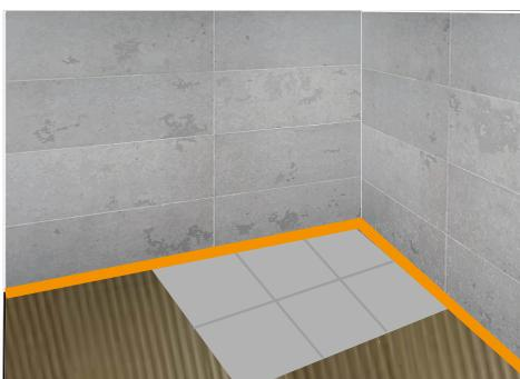
\*\* Installez une bande périphérique entourant les bords de la pièce pour s'adapter à tout mouvement variable entre le revêtement de sol fini et les murs.
