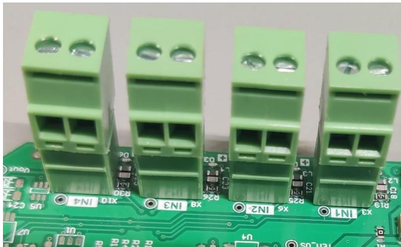
Uređaji koji nisu zabrvljeni brtvenom masom dolaze bez kabela. Davač(i) impulsa i tamper-i spajaju se direktno na konektore na tiskanoj pločici.
