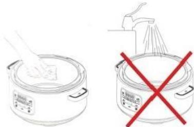
3. 内锅和玻璃盖清洁：内锅和玻璃盖可直接浸泡水中或用水直接冲洗，请用柔软的海绵清洗干净，然后用干软布擦干晾干后才能放入到主机中。
