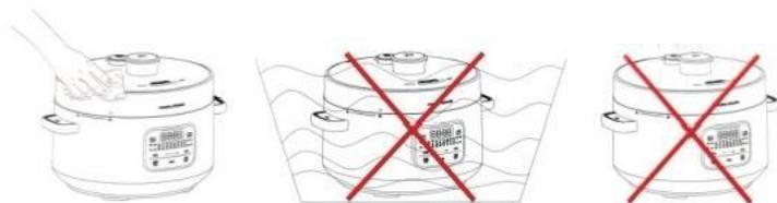
2. 外锅清洁：定期对外锅内壁和发热盘用干净的湿布拧干后擦拭，再用干毛巾擦干表面，切勿直接往外锅内部用水冲洗！
