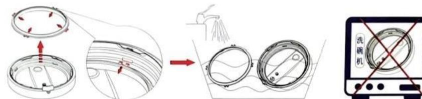
5. 浮子、排气管和限压阀清洁：可用水直接冲洗排气管，浮子是可拆出来清洗的，只需将与浮子相扣合的浮子密封圈拔出，再用清水冲洗，清洗后再将浮子密封圈扣入到浮子中即可，如下图所示。限压阀可直接浸泡水中或用水直接冲洗，再用干软布擦干即可。
