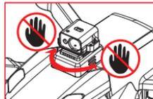
Al desmontar el equipo de evitación de obstáculos, debe desconectar la alimentación del dron antes de desmontarlo, de lo contrario dañará el equipo de evitación de obstáculos y afectará al uso normal. **Apague el dron, retire el equipo de prevención de obstáculos y, a continuación, instale la cubierta de posición del equipo de prevención de obstáculos.**
