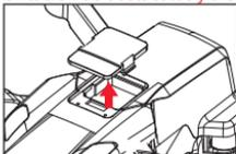
1. Retire la cubierta de la posición de instalación del equipo para evitar obstáculos
