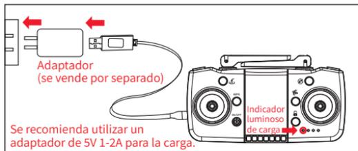
Inserte la clavija de carga del cable de carga en la toma de carga del mando a distancia y, a continuación, conecte la clavija del cargador USB al ordenador o al cargador del teléfono móvil para cargarlo, la luz indicadora de carga se encenderá durante la carga y la luz indicadora se apagará cuando esté completamente cargado. (El tiempo de carga es de unos 60 minutos)
