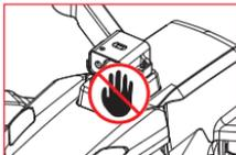
Al abrir el producto, no toque el equipo de evitación de obstáculos, ya que el equipo de evitación de obstáculos está en estado de funcionamiento de energía, el toque no autorizado hará que el equipo de evitación de obstáculos no pueda funcionar correctamente, la probabilidad de daños a la función del equipo de evitación de obstáculos.
