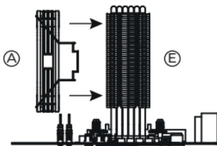
Coloque el ventilador (A) en el radiador (E) y sujete con los clips a los laterales del radiador.
