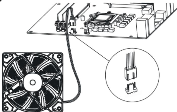
Conecte el cable del ventilador al conector CPU\_FAN de la Tarjeta madre.
