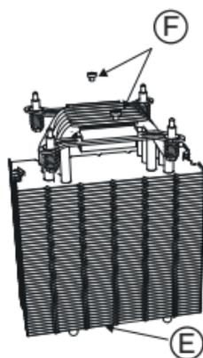
Fija los Brakets de montaje (B) en el radiador (E) con los tornillos (F).
