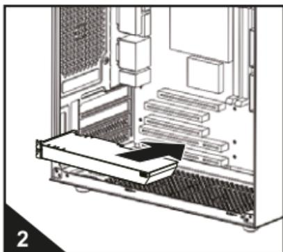
Retire los tornillos de la barra de fijación colocados ranuras PCI, quite la barra de sujeción y por último remueva las tapas de las ranuras PCI.
