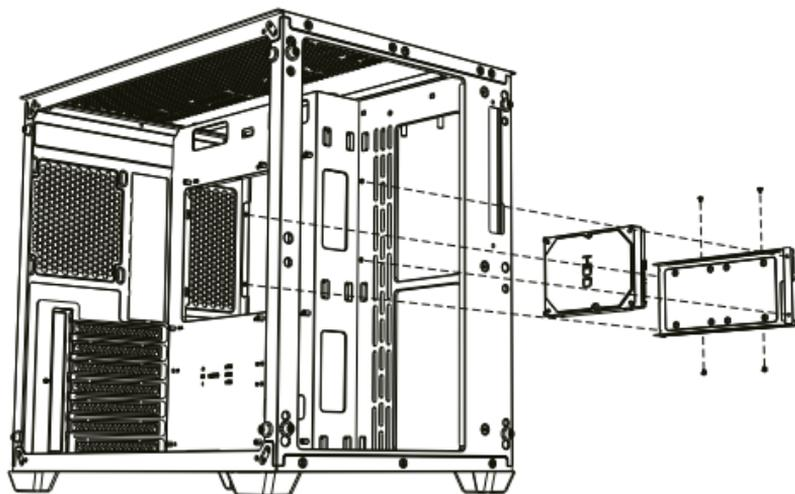
Instale el HDD en la placa base como se muestra y fije los tornillos en "a".
