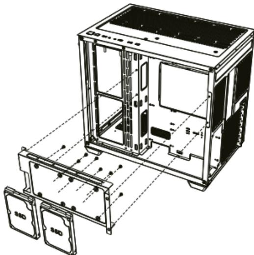
Instale el SSD en la placa base como se muestra y fije los tornillos en "a".
