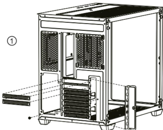
2) Inserte la tarjeta de video en la ranura PCI de la M/B siguiendo la dirección de la imagen.
