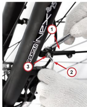
Wenn die Hebeöse des vorderen Kotflügels installiert ist, heben Sie den Kotflügel bitte so weit wie möglich an, um den Kotflügel nicht mit dem Reifen zu behindern. Weitere Einstellungen und Wartungsarbeiten finden Sie im Kapitel: „6 Montage“
