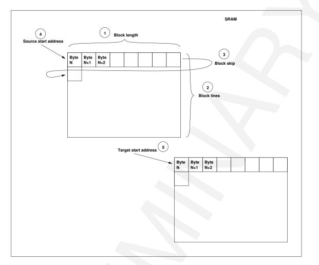
Figure 15: Block move parameters
