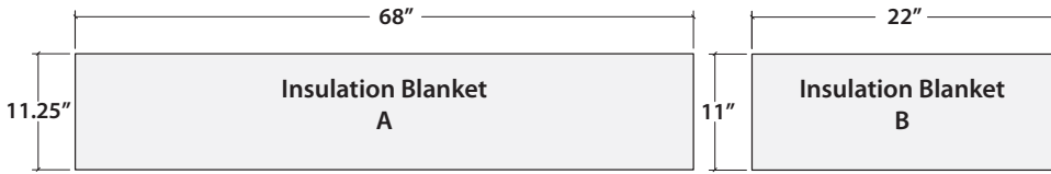
Mini Ceiling Mount blanket dimensions
