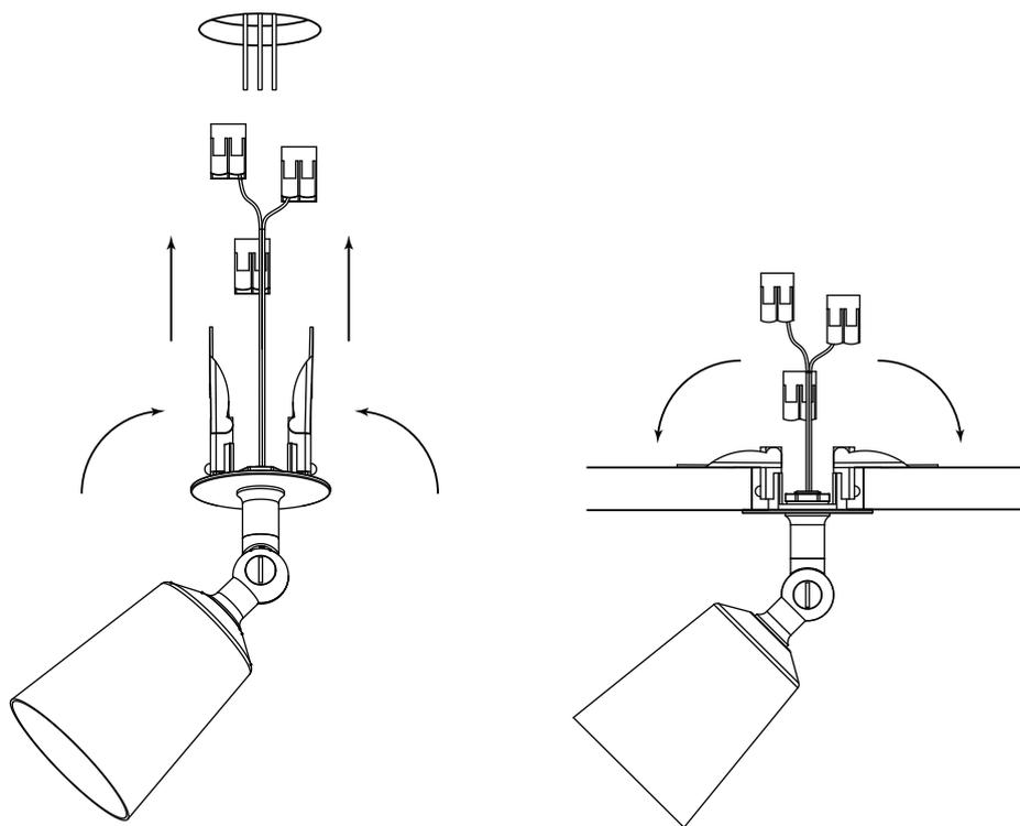
Setzen Sie eine 50-mm-GU10-Glühbirne (Arthur oder Chester) oder eine 35-mm-Glühbirne (Court) ein. Testen Sie das Licht, um sicherzugehen, dass der Anschluss korrekt durchgeführt wurde.
