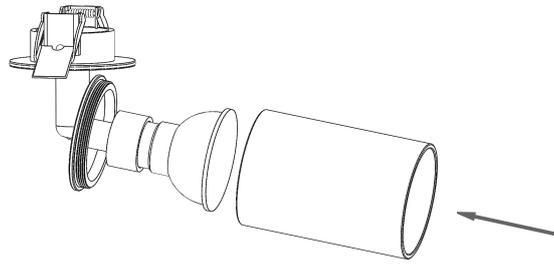
Die Leuchten sind für die Montage an Decken oder Wänden mit Hohlraum konzipiert. Sie benötigen eine 50-mm-Lochsäge. Bohren Sie das Loch und schließen Sie die Drähte an den Stromkreis an.
