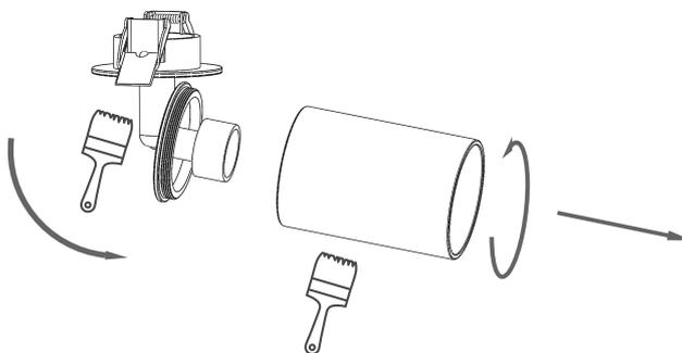
Wir empfehlen zwei dünne Farbschichten. Achten Sie darauf, das Gewinde nicht mit Farbe zu beschmieren, damit sich der Strahler nach dem Lackieren wie vorher drehen und schwenken lässt.
