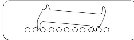
Messen des Kettenverschleißes. Bei einer neuen Kette sinkt das Messwerkzeug nicht zwischen die Kettenglieder ein.
