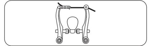
Falls ein Bremsgummi an der Felge schleift: Durch die Federeinstellschrauben können Sie die Rückfederkraft so einstellen, dass sich beide Bremsgummis gleichmäßig von der Felge abheben, wenn Sie den Bremshebel loslassen. Anschließend überprüfen Sie die korrekte Funktion der Bremse.
