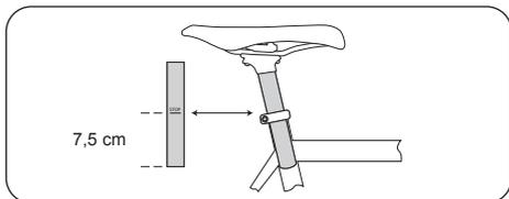
Eine Mindestsattelhöhe richtet sich nach den Körpermaßen des Fahrers, er muss ohne Beeinträchtigung von Fahrsicherheit oder Gesundheit mit dem Pedelec fahren können. Die Sattelstütze muss immer mindestens so weit ausgezogen sein, dass sie noch sicher von der Sattelstützenklemmung geklemmt wird.
