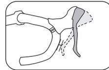
Nachstellen der Bremse ist bei mechanischen Bremsen meist mit einer Einstellschraube am Griff möglich. Drehen Sie die Einstellschraube soweit aus dem Griff, dass ein sicheres Bremsen möglich ist. Sichern Sie diese Position durch Feststellen der Kontermutter am Griff.
