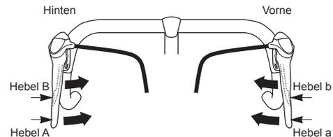
Hebel (A): Umschalten auf einen größeren Zahnkranz
