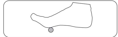
Wenn Sie mit Klickpedalen fahren, sollten Sie die Pedalplatten so einstellen, dass diese Fußstellung gewährleistet ist. So werden Schäden am Bewegungsapparat verhindert und größtmögliche Kraftübertragung gesichert.
