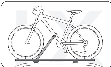
Ein Carbonrad ist nicht geeignet, auf dem Dach eines Autos transportiert zu werden, da die Räder in der Regel mit einer Klammer, die ein Rahmen-Rohr umgreift, befestigt werden. Auch die Hersteller von Anbauteilen und Zubehör halten Informationen zu Verwendung und Montage auf Ihren Internetseiten bereit. Informieren Sie sich, wenn Sie etwas Neues nutzen.
