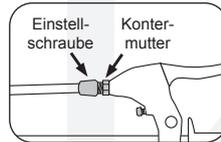
Um die Bremshebel auch bei kleineren Händen sicher greifen zu können, wird der Bremshebel mit einer
