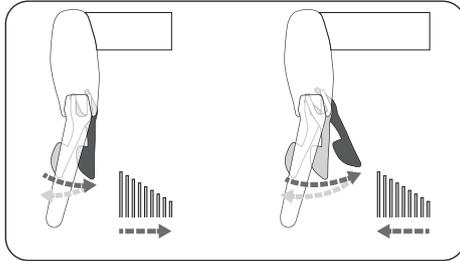
Der Schalthebel hinter dem linken Bremshebel schaltet bei kurzem Schaltweg vorne aufs kleine Kettenblatt, bei langem Schaltweg aufs große Kettenblatt.
