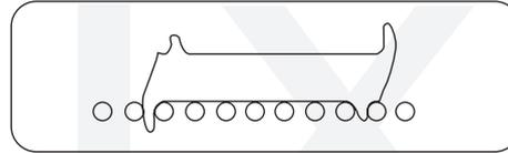
Wenn eine Kette so verschleßen wie diese ist, sinkt das Messwerkzeug komplett ein. Diese Kette muss ausgewechselt werden.
