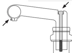
Mögliche Positionen von Schraubverbindungen zur Anpassung
