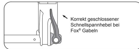
Korrekt geschlossener Schnellspannhebel bei Fox® Gabeln
