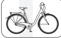
Räder des Typs 1 sind z.B. Cityräder oder Tourenräder. Der Fahruntergrund muss eine normale und befestigte Oberfläche sein. Die typische Geschwindigkeit liegt zwischen 15 bis 25 km/h. Die Reifen sollen den Bodenkontakt halten. Gelegentliches vorsichtiges Befahren von Absätzen (z.B. Bordsteinkanten) von max. 15 cm ist möglich.
