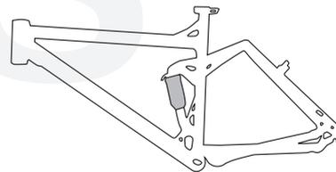
Hier ist der Hinterbau des Rahmens beweglich gelagert und mit einem Stoßdämpfer gefedert und gedämpft.
