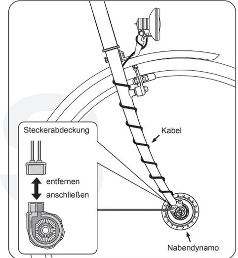
Wenn Ihr Fahrrad einen Nabendynamo verwendet, können Sie diesen einfach auf der Rückseite ihres Vorderradscheinwerfers mit einem Schalter ein- oder ausschalten. Wenn die Beleuchtungsanlage Ihres Fahrrades einen Lichtsensor hat, schaltet sich der Dynamo automatisch ein oder aus.
