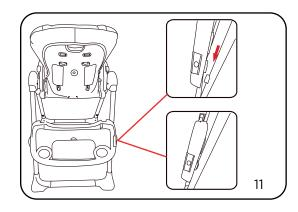
Para guardar la bandeja de comer apoyada en la estructura, coloque el seguro en ambos lados de la bandeja al mismo tiempo.
