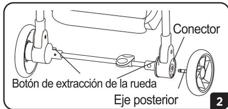
**2-Instalación ruedas traseras:** El eje trasero debe quedar ensamblado en el conector de la rueda. Escuchara el sonido "click" si la instalación se encuentra correcta. Para quitar presione el botón de extracción y retire hacia afuera.
