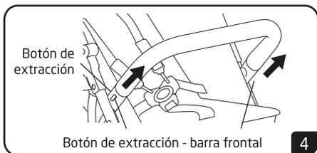
**4 Barra Frontal:** Para retirar la barra frontal, presione los botones ubicados en los costados como se muestra en la imagen. Para insertar nuevamente, ajuste los conectores y presiones hasta que escuche el sonido "click".
