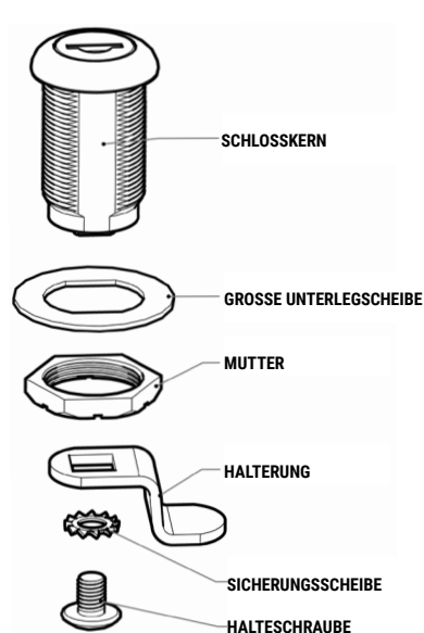
Abbildung 2: Explosionsansicht des Schlosskerns
