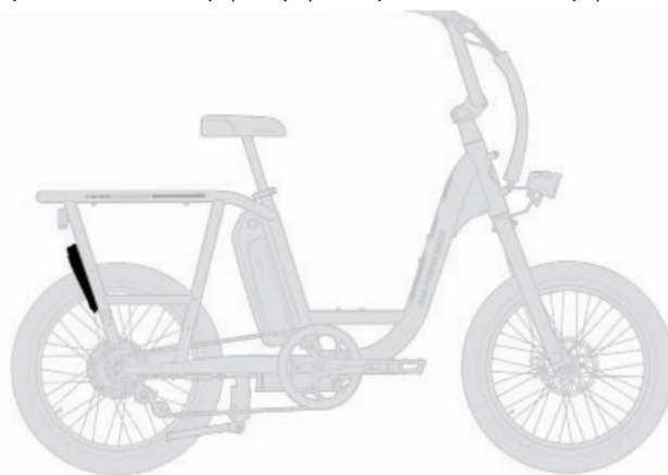
Figura 3: Ubicación de montaje del marco n.º 2
