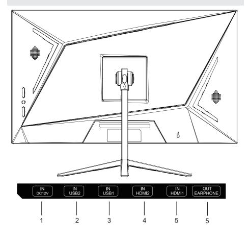
1. DC-DC IN 12V (5V) 2. USB2-USB1 IN (2. 0) 3. USB1-USB1 IN (2. 0 4. HDM12-HDM1 IN (1. 4) 5. HDM11-HDM1 IN (1. 4) 6. EARPHONE-EARPHONE OUT
