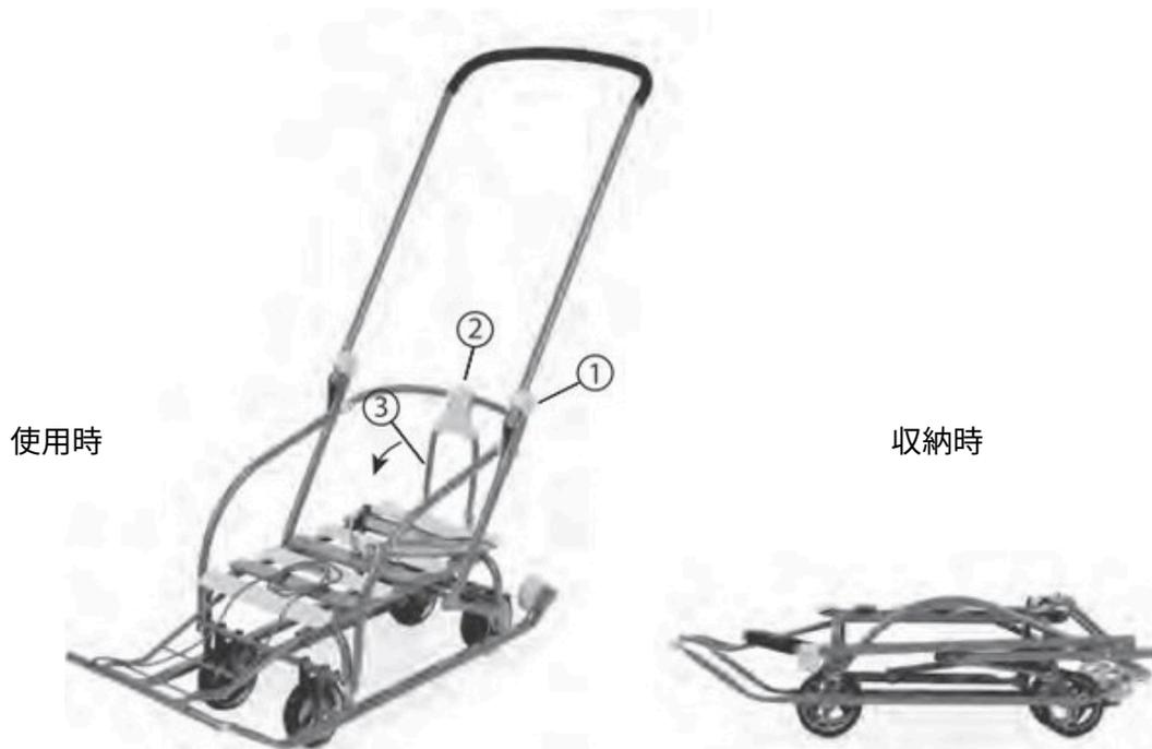
折りたたんだ状態（収納時）から使用するために展開する際には、①のハンドル固定部を固定し、②のストッパーを掛けてください。使用時から折りたたむ際には、①の固定部を解除し、②のストッパーを外し、③の方向に折りたたんでください。
