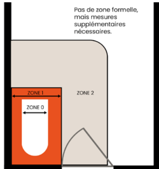
Fig. 02 : montage dans les pièces humides et les salles de bains
