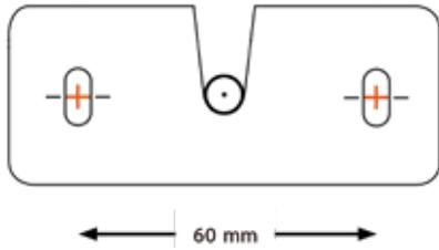
Abb. 03: Bohrflöcher
