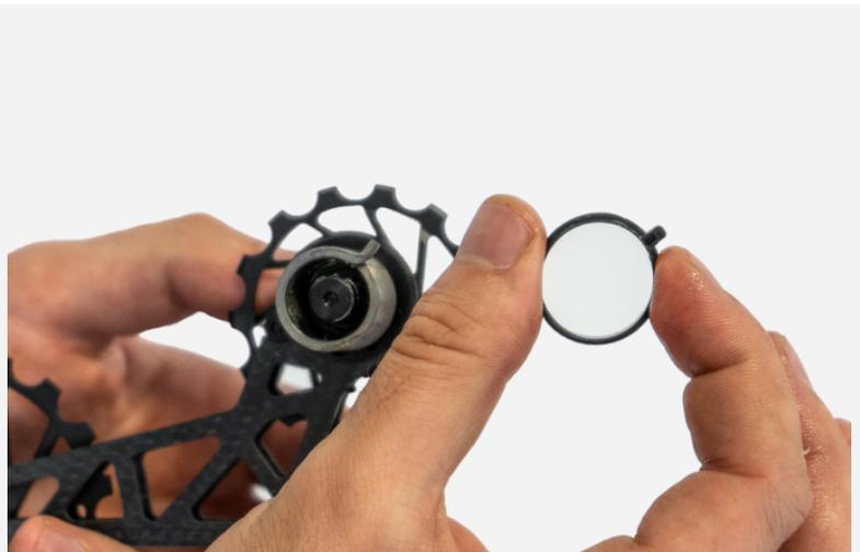
2. Placez la cage Nova Ride dans le dérailleur et tournez-la dans le sens inverse des aiguilles d'une montre, comme indiqué sur l'image.
