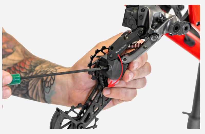
2. Re-installer le stoppeur, avec un peu de Loctite, à l'aide du tournevis plat.
