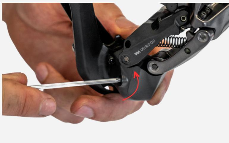
5. Tenez fermement la chape Shimano et faites la tourner dans le sens des aiguilles d'une montre pour l'enlever.
