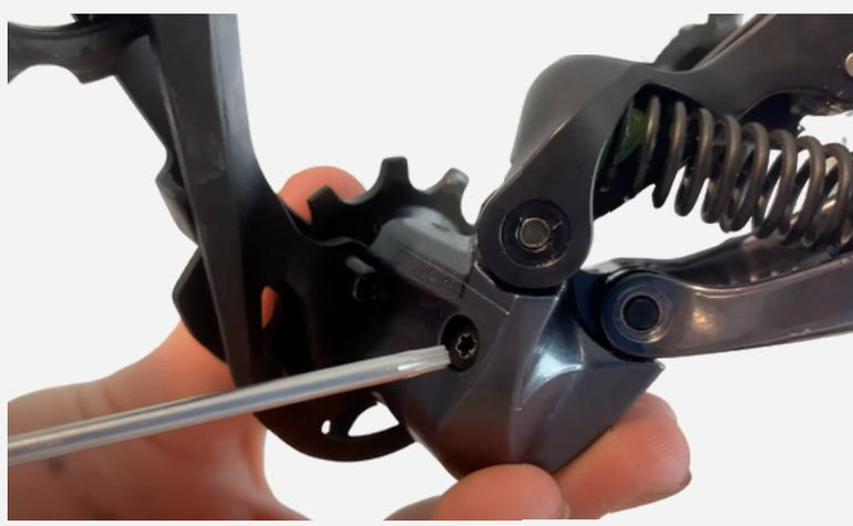
5. Tenez fermement la chape Shimano et faites la tourner dans le sens des aiguilles d'une montre pour l'enlever.
