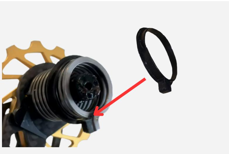
2. Placez la cage Nova Ride dans le dérailleur et tournez-la dans le sens inverse des aiguilles d'une montre, comme indiqué sur l'image.
