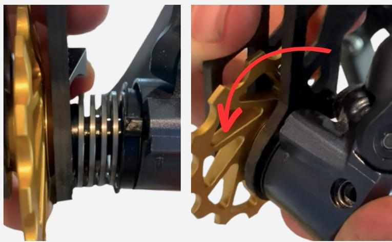
3. Faites la pivoter jusqu'à ce que le stoppeur (entouré en rouge) vienne en butée sur le dérailleur (trait bleu).
